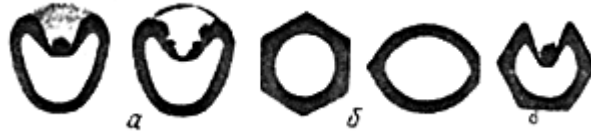
Рис. 26. Способы опрессовки: а - местное вдавливание; б - сплошное обжатие; в - многогранное обжатие с местным вдавливанием
