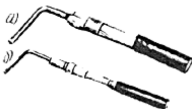
Рис. 19. Образцы контактных соединений стальных стержней с алюминиевыми жилами кабеля: а - с разрезом сварного соединения; б - без разрыва сварного соединения
